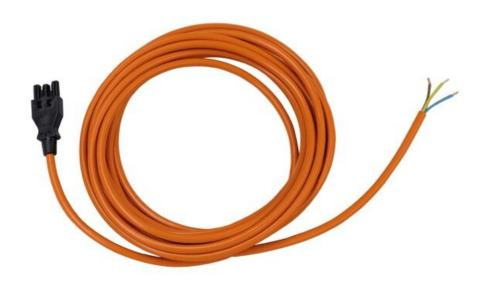
81430 Ref. Color naranja EAN Material PVC cubierta del Unidad de embalaje cable Certificado UL cURus (in progress) Longitud del 3.000 mm cable de conexión Tipo de **Terminales** de cable, conector Conector GST 18 Tensión 230 V AC
