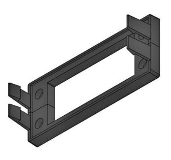
EAN 4251269323 per viti 720 Diam. dei fori 5,5 mm Unità di 10 per viti imballaggio Adatto a KEL 24, KEL-Lunghezza 155 mm U 24, KELpassacavi: 64 mm QUICK 24, Larghezza Altezza 38 mm KEL-FA 24, Altezza di 38 mm **KEL-FG-A**
