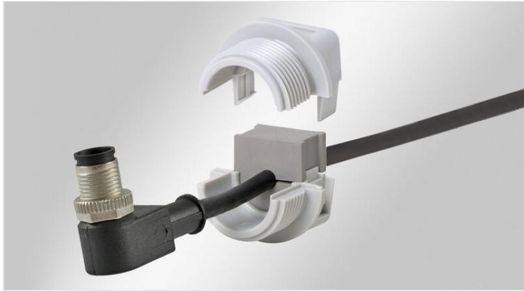
QVT是一种圆形可分式电缆格兰头,可快速,轻松地安装预端接的电缆或完整的线束。同时不带端子或连接器的电气,气动或液压管线以及波纹管也可以轻松布线,并满足IP54防护等级。QVT系列产品非常小巧,特别适合小型机器,设备和仪器。
